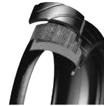
Pneu à ceinture acier 0° avec carcasse radiale (90 degrés)
