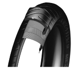
Pneu ceinturé avec carcasse radiale (90 degrés)
