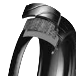
CONSTRUZIONE RADIALE CON CINTURA INCROCIATA (90 GRADI)
