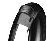
PNEUMATICO RADIALE CON CINTURA INCROCIATA (90 GRADI)
