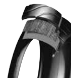
NEUMÁTICO CON CINTURA A 0° Y CARCASA RADIAL (90 GRADOS)
